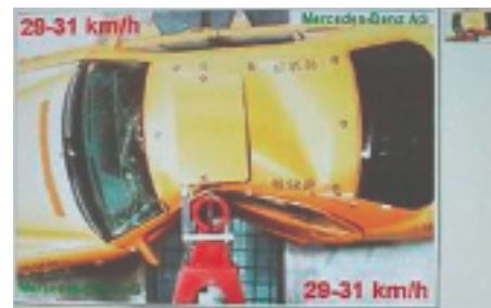
Test de déformation pour déterminer les équivalences « vitesse/déformation ».
