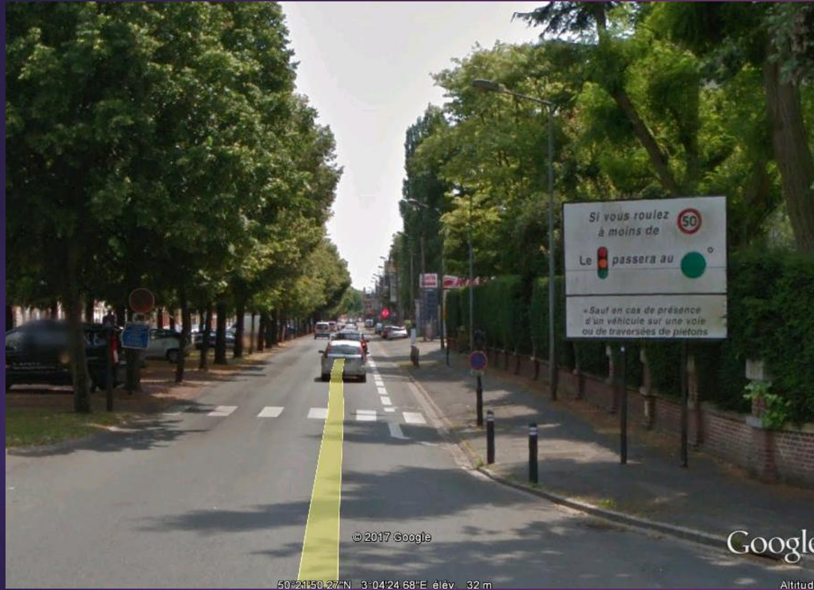
Feux asservis à la vitesse
